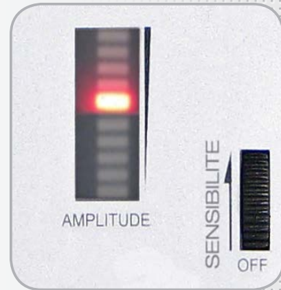
Indication visuelle des fuites et réglage de sensibilité
