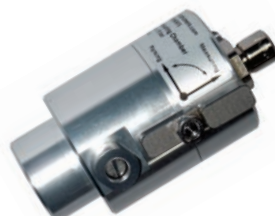
Chambre de mesure, avec position de mise en zone sèche du capteur, pour des temps de réaction rapides (Echantillonnage 4 l/min à 8 bars)
