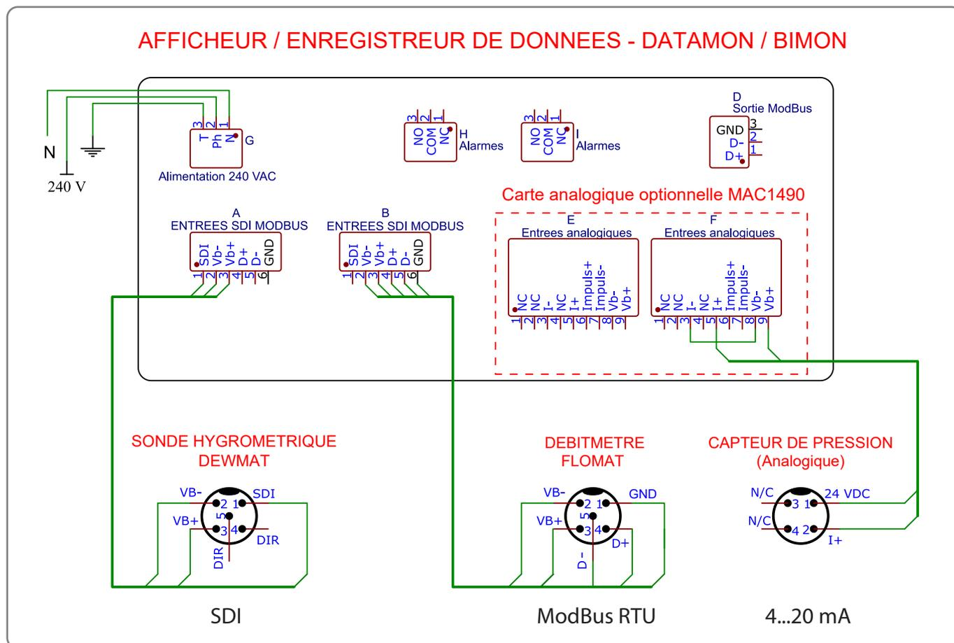
Cet exemple de câblage décrit les diverses possibilités pour connecter différents capteurs à l'afficheur de données BIMON et/ou l'afficheur enregistreur de données DATAMON.
