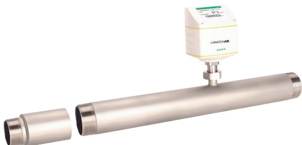
Redresseur d'écoulement disponible en option pour limiter la longueur des sections de mesure en amont/aval du débitmètre.
