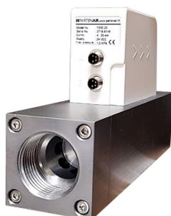
Tous les débitmètres FLOTIP intègrent un redresseur d'écoulement. De ce fait, ils ne nécessitent pas de longueur minimale de tuyauterie en amont et en aval.
