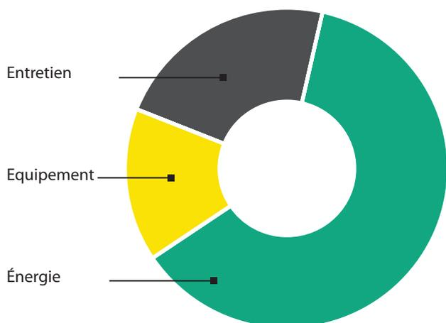
Les compresseurs modernes transforment 90% de la puissance électrique en chaleur et seulement 10% en air comprimé. Autrement dit, l'air comprimé est 10 fois plus cher que l'électricité. Il est habituel de mesurer la consommation électrique, mais seules quelques entreprises mesurent leur consommation d'air comprimé.
