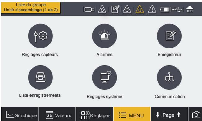
Les valeurs mesurées sont affichées simultanément jusqu'à quatre capteurs par page. Il est possible de faire défiler les pages pour afficher d'autres capteurs et leurs valeurs mesurées.
