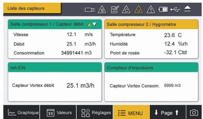
Les graphiques permettent d'analyser sur site les canaux sélectionnés et de détecter aussitôt les problèmes.
