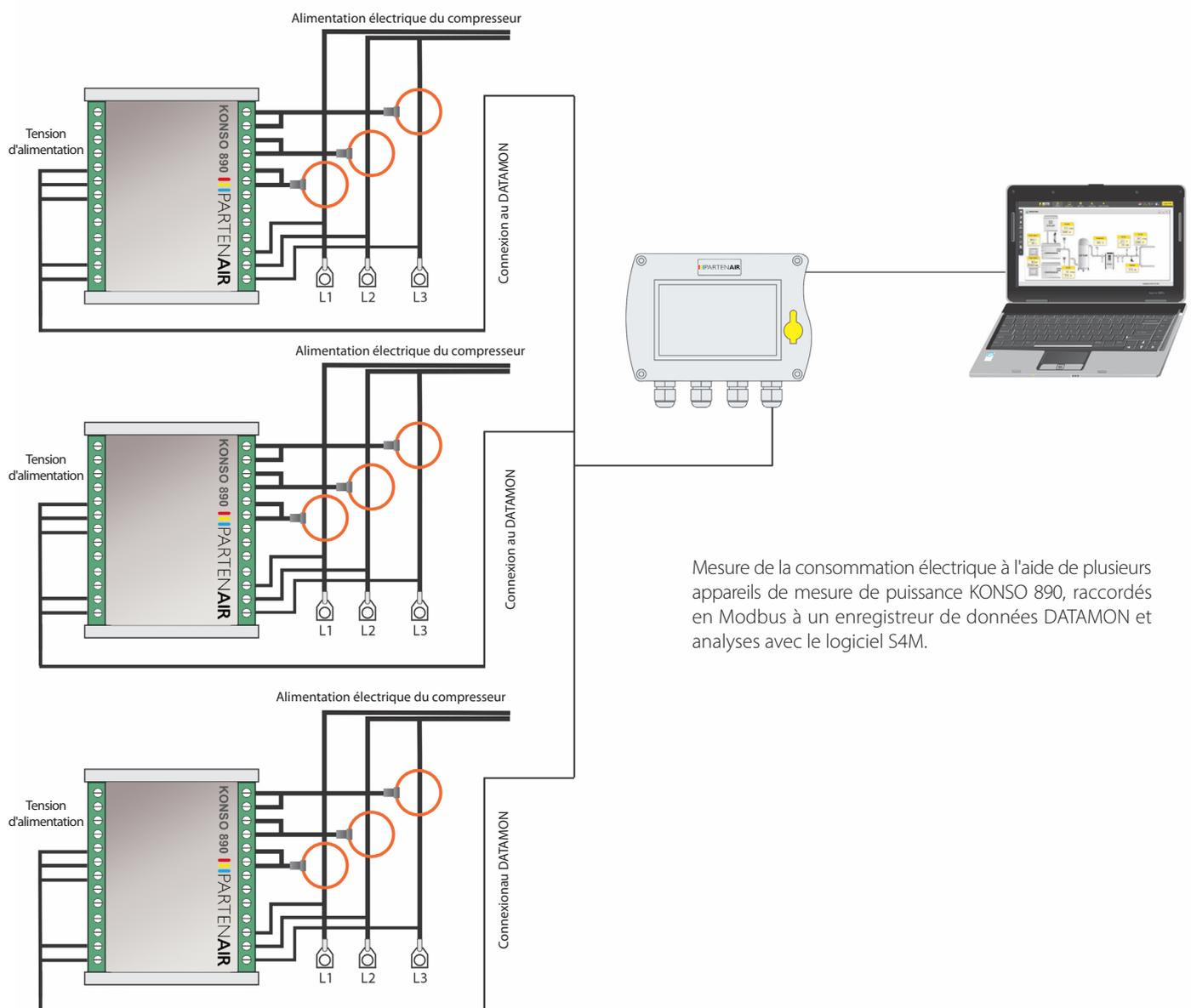
Mesure de la consommation électrique à l'aide de plusieurs appareils de mesure de puissance KONSO 890, raccordés en Modbus à un enregistreur de données DATAMON et analyses avec le logiciel S4M.
