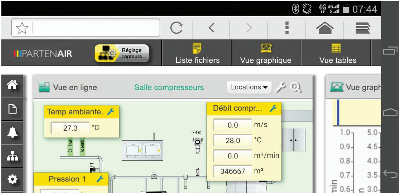
L'exemple ci-dessus montre la surveillance d'une installation typique d'air comprimé avec tous les paramètres importants affichés en ligne sur l'écran.
