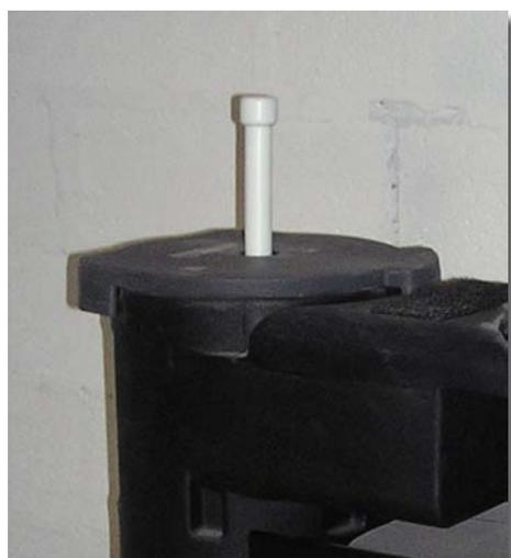
**L'indicateur blanc, au contraire, doit être visible** car il repose sur l'élément adsorbant qui flotte en surface des condensats. Au fur et à mesure de sa saturation, l'élément s'enfonce progressivement et la portion visible de l'indicateur diminue en conséquence. **Lorsque cet indicateur n'est plus visible, il faut remplacer les éléments filtrants** pour garantir la teneur en hydrocarbures dans les rejets.
