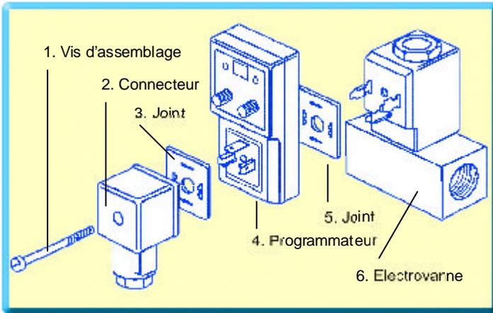
En effet, un serrage correct de la vis d'assemblage est impératif pour assurer une étanchéité correcte entre les divers composants électriques par les joints rep. 3 et 5.
