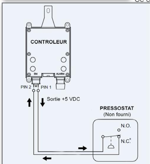
En configuration usine, tous les sècheurs, et les contrôleurs fournis en pièce de rechange, sont munis d'un pont sur les bornes 1 et 2 du connecteur "EM" (voir photo.)
