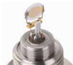
Ces capteurs utilisent la technologie de pointe **QCM** (Quartz Crystal Measurement) à même de mesurer les modifications d'humidité de l'ordre du ppb (1 partie par milliard)
