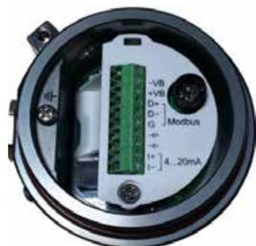
Bornier à vis, avec identification des signaux, situé à l'intérieur du boîtier de raccordement.
