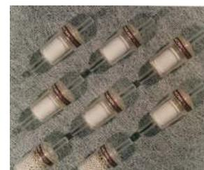
Construction : nylon transparent. Pression de service maximum : 9 bars. Température maximum d'utilisation : 50° C. Perte de charge initiale : de 0.1 à 0.14 bar. Perte de charge saturé (micra DIF) : 0.4 bar.
